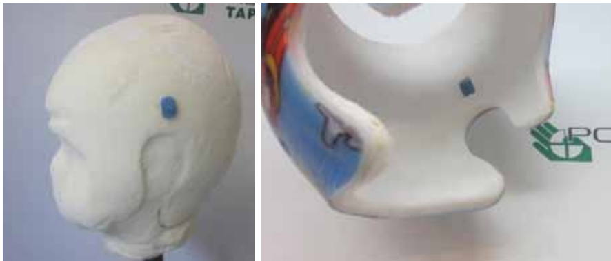
Abb. 2 u. 3: Mikrosensor-Einbau in das Hilfsmittel. Quelle: Pohlig/Tappe Wien
